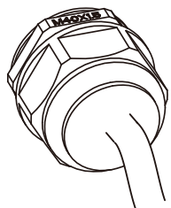
Figura 5.11 Serraggio della scatola di derivazione CA
